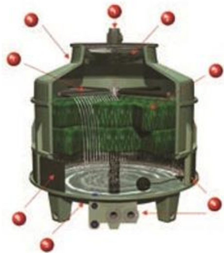
شکل ۸-۴ برج خنک کن
