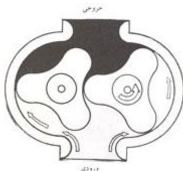
شکل ۱-۱۳: یک پمپ دنده‌ای از نوع گوشواره ای
