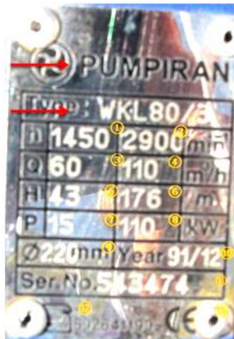
شکل ۳-۲۸: پلاک پمپ ساخت پمپ ایران
