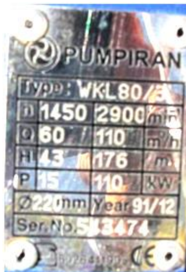
شکل ۲۷-۲: پلاک پمپ ساخت پمپ ایران
